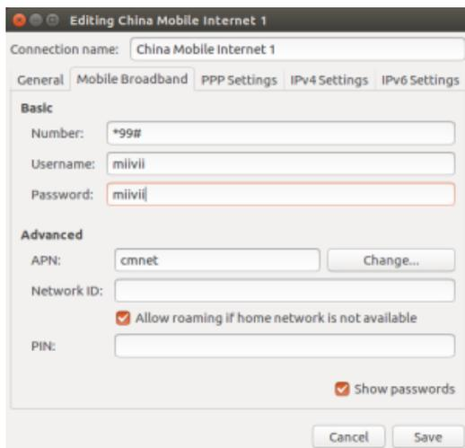
网络创建完成后，在桌面右上方网络连接图标中选中新建的网络连接，就能够正常上网了。若需要4G网络开机自动连接设置，已移动为例，建立好连接文件China Mobile Internet后操作如下：点击桌面上方网络连接图标，在下拉菜单中点击Edit Connections选项。在弹出的窗口中选中China Mobile Internet选项，点击下方设置图标
