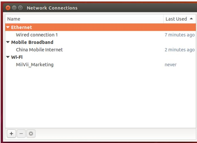
弹出的窗口中选择General选项，并勾选Automatically connect to this network when it is available选项之后保存退出。重启米文设备，就可以在输入开机密码后自动重连4G网络
