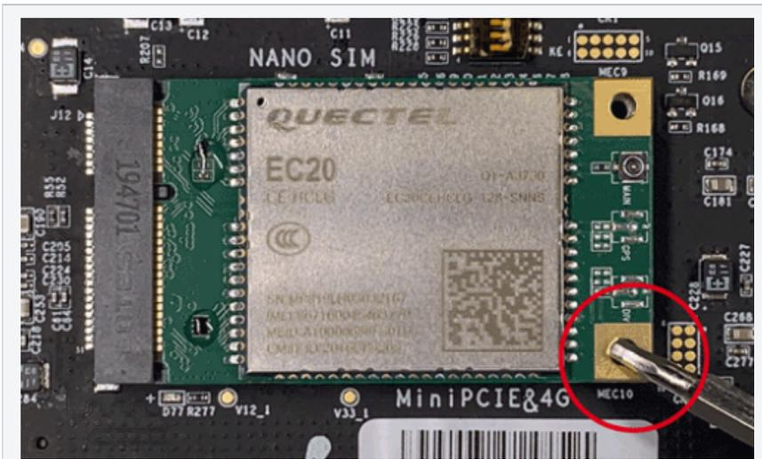
图 模块安装示意图
